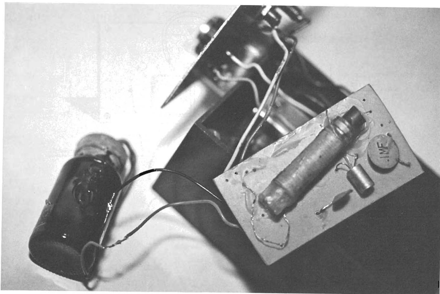
alta frequenza dagli impulsi modulatori di bassa frequenza. Esso in pratica rettifica il segnale modulato di alta frequenza « tagliando via » o le semionde negative o le semionde positive (a seconda di come è collegato).
