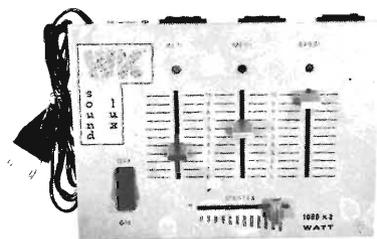
**LUCI PSICHEDELICHE 3 canali** amplificati 3.000 Watt: compl. monitor a led, circuito ad alta sensibilità, 1.000 Watt a canale, controlli-alti-medi-bassi-master alimentazione 220 Vca
