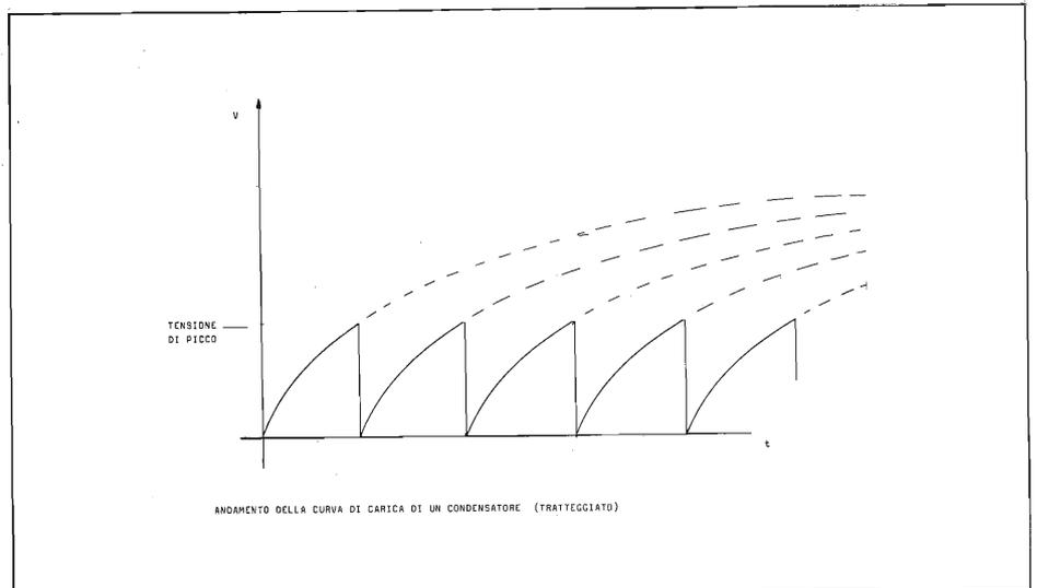
il che si ottiene elevando la tensione di emettitore ad un valore superiore alla tensione di picco precedentemente rilevata, la resistenza della giunzione assume un valore vicino allo zero. Tale stato di cose permane sino a che la giunzione P-N non viene nuovamente polarizzata inversamente, il che si ottiene facendo scendere la tensione di emettitore al di sotto della tensione di picco.
