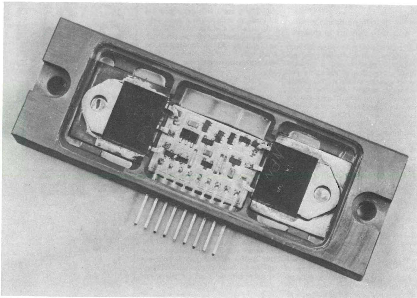
I moduli OM 931 e 961, integrati ibridi a film sottile. Pochi componenti per eccezionali amplificatori da 30 e 60 watt stereo di potenza. Alta affidabilità, semplicità costruttiva.
