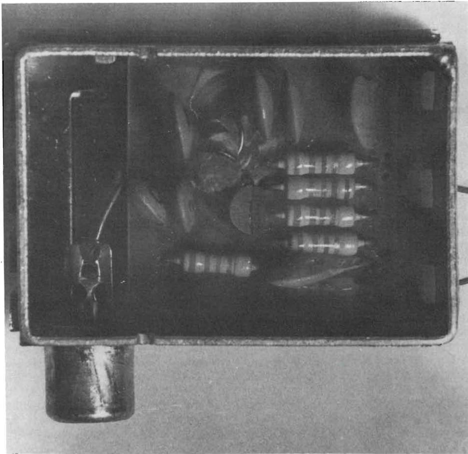
ferire con altri circuiti eventualmente presenti sulla stessa linea di alimentazione. Ricordiamo, inoltre, che il collegamento della modulazione (BF) deve essere effettuato con cavetto schermato di buona qualità e il collegamento al televisore (RF) con cavo coassiale per TV avente un'impedenza di 75 ohm.
