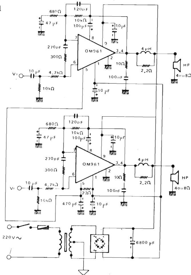
Esempio d'impiego di due moduli OM 961 per la realizzazione di un amplificatore b.f. Hi-Fi stereo con potenza d'uscita di 60 W.
