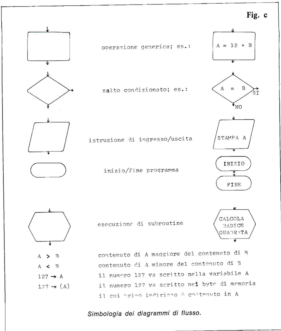
il cui unico operando è il nome della subroutine, il programmatore può far eseguire la subroutine tutte le volte che ciò è necessario (figura F). Alla fine di ciascuna esecuzione delle subroutine (istruzione RETURN), il program counter viene riportato automaticamente al valore dell'indirizzo dell'istruzione immediatamente successiva alla CALL; questa istruzione viene quindi eseguita subito dopo la RETURN.
